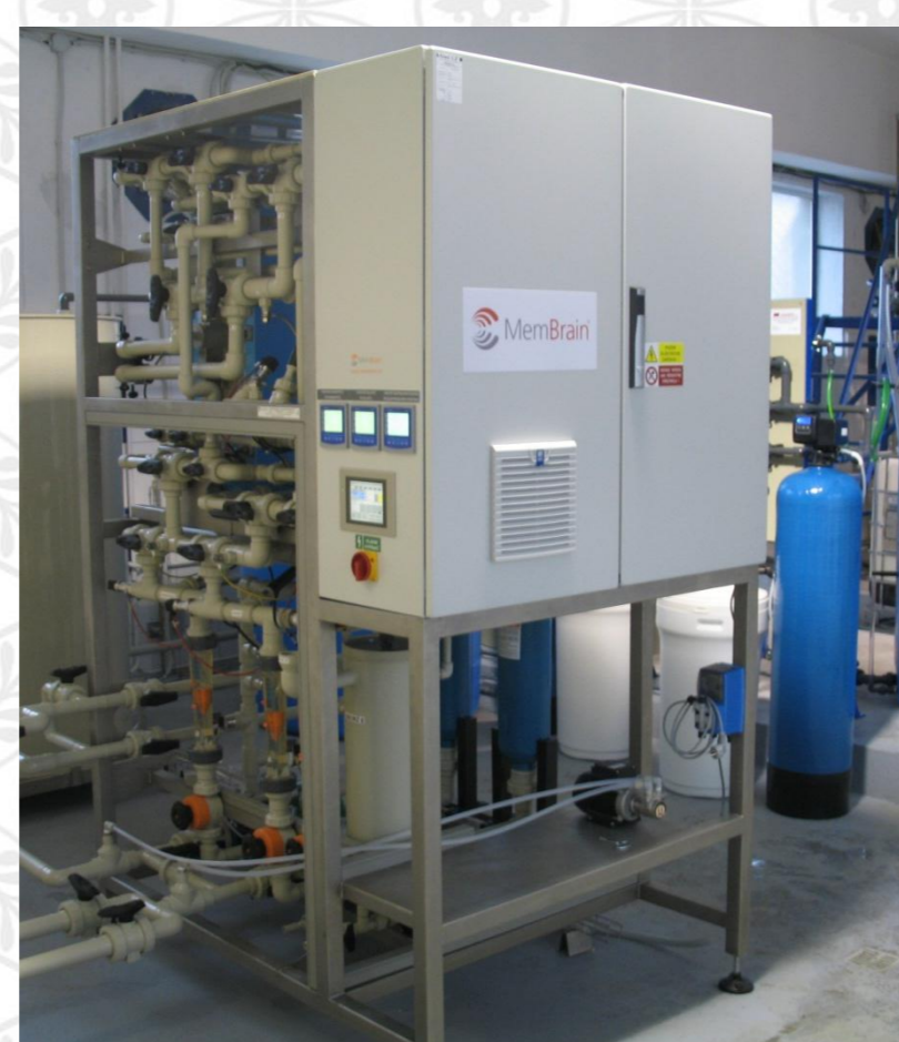
Obr. 3: Pilotní jednotka elektrodialýzy ED-X
