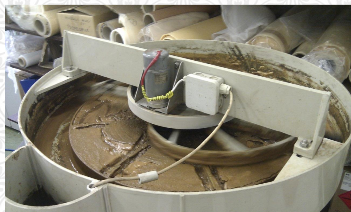
Obr. 1: tvorba flotační pěny
