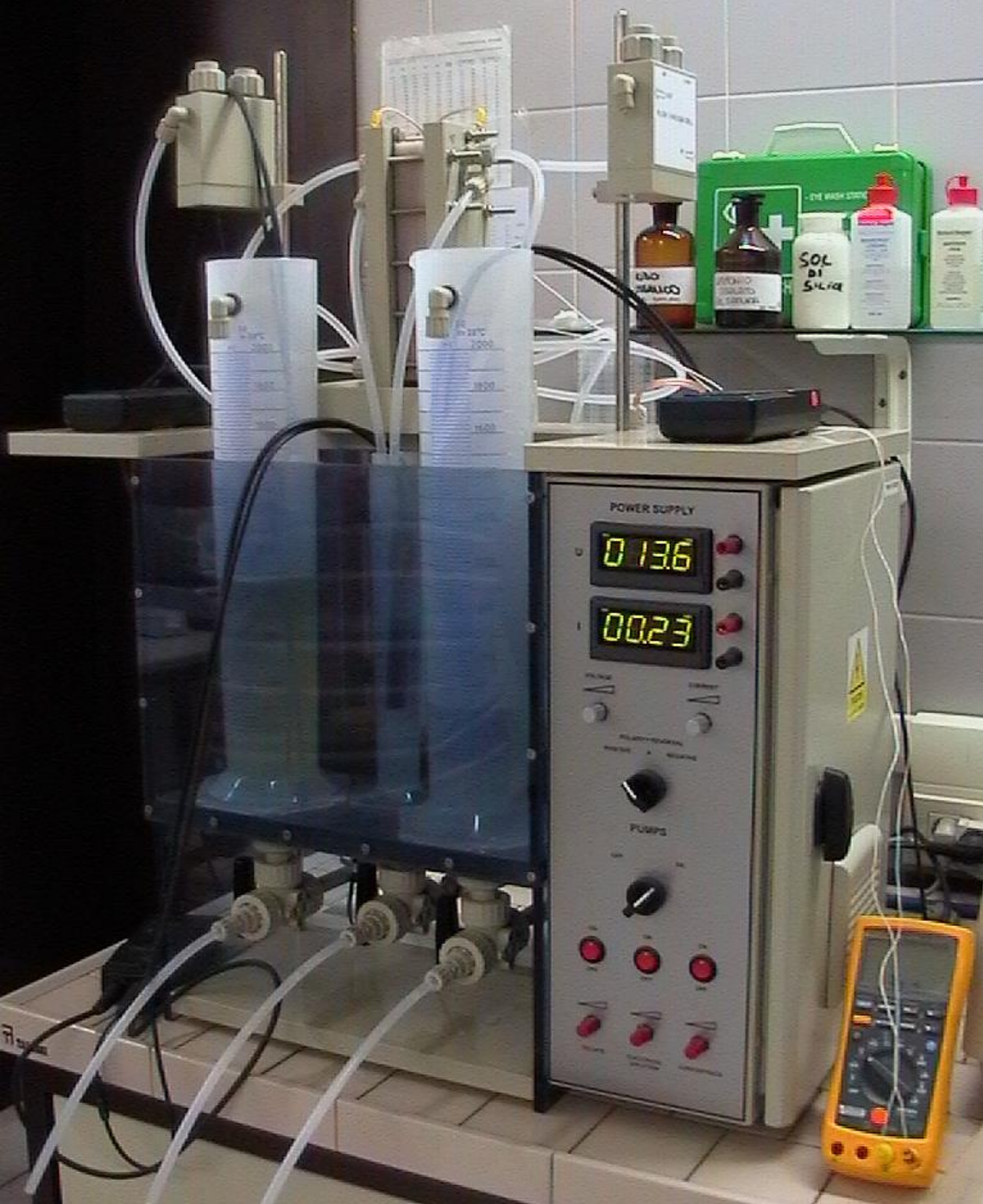
Stabilizace vína procesem ED (laboratorní test)
