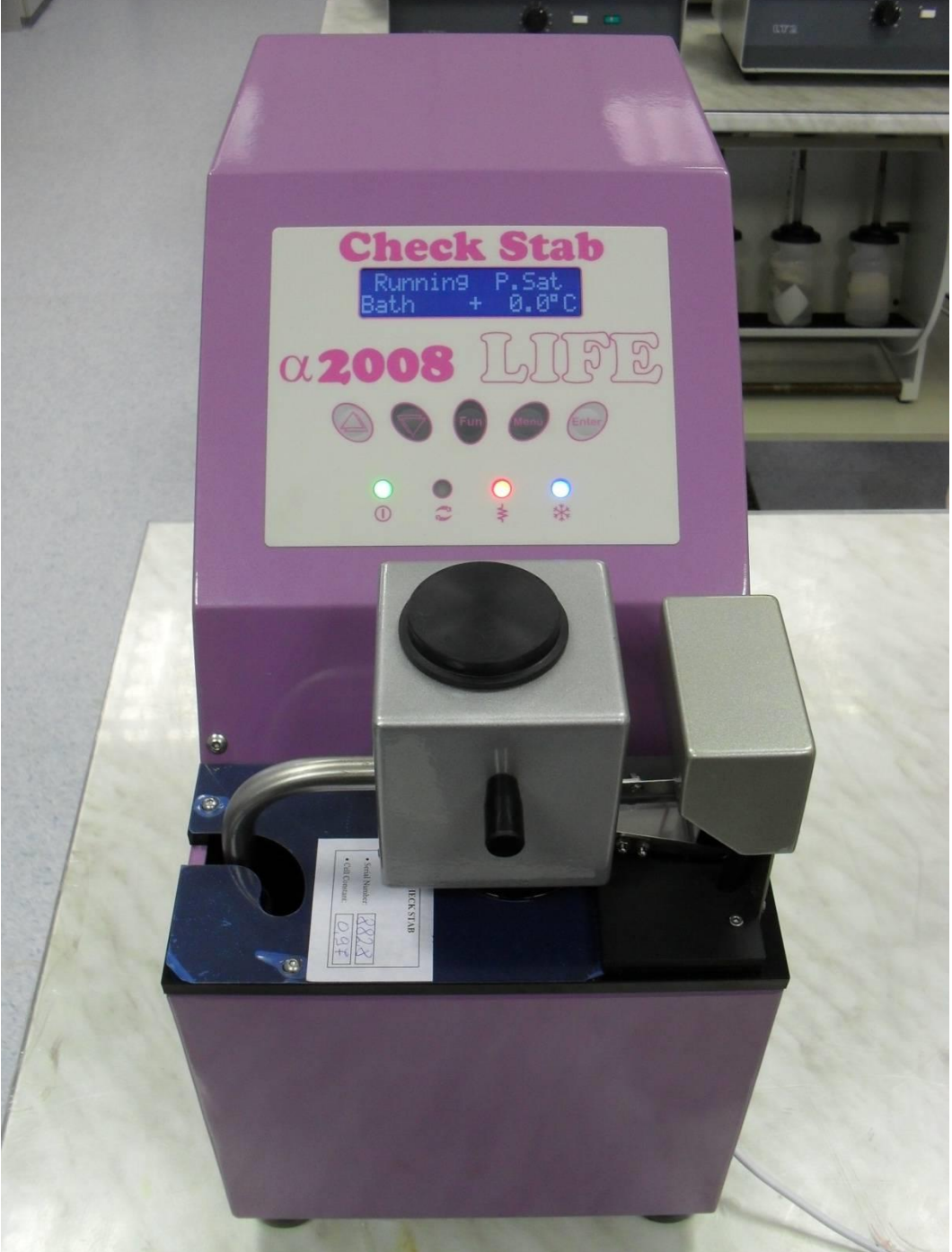
Určení bodu stability vína na základě změny konduktivity při vysrážení KHT
