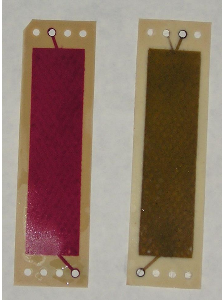
Provozně zatížené ionexové membrány po zpracování červeného vína k analýze a optimalizaci CIP (anthokyaniny)
